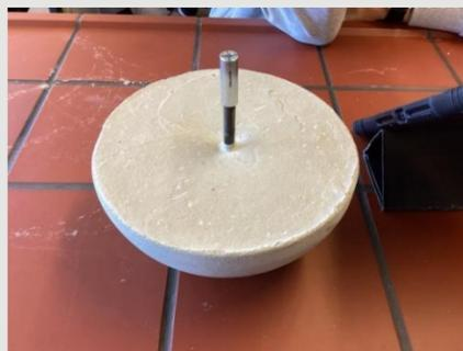
Danach wird der Planet geschliffen. Es wird mit eine groben Körnung P80 angefangen und dann je nach Bedarf feiner bis zur Körnung P120 oder P240 gearbeitet. Das Schleifpapier muss leicht gerundet in der Hand gehalten werden, damit die Kugelform erhalten bleibt und keine planen Flächen geschliffen werden. Die Schleifarbeiten wurden auf dem Schulhof durchgeführt, um die Aufnahme von Schleifstaub gering zu halten. Bei Bedarf konnten auch Staubschutzmasken aufgesetzt werden.
